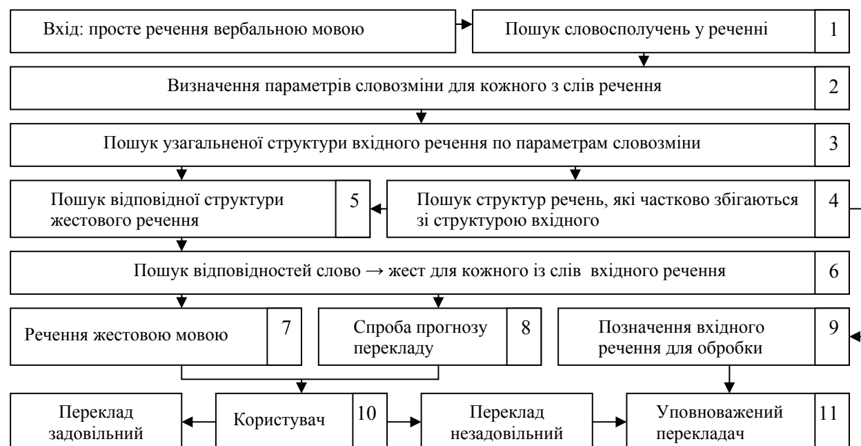
Рис. 4. Алгоритмічна схема автоматизованого перекладу
