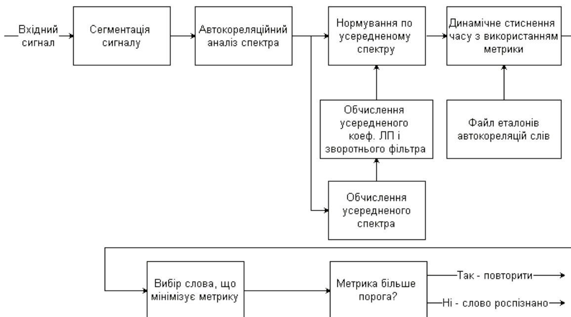
Рис. 1. Структурна схема CPM на основі кореляційного аналізу
