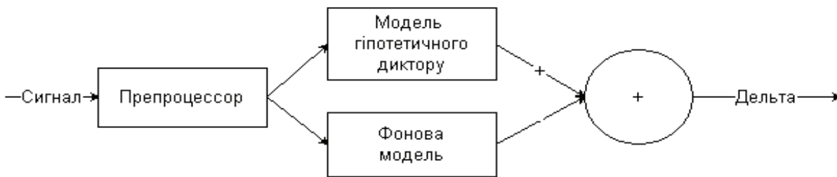
Рис. 6. Загальна схема алгоритму розпізнавання, побудованого на відношенні правдоподібності
