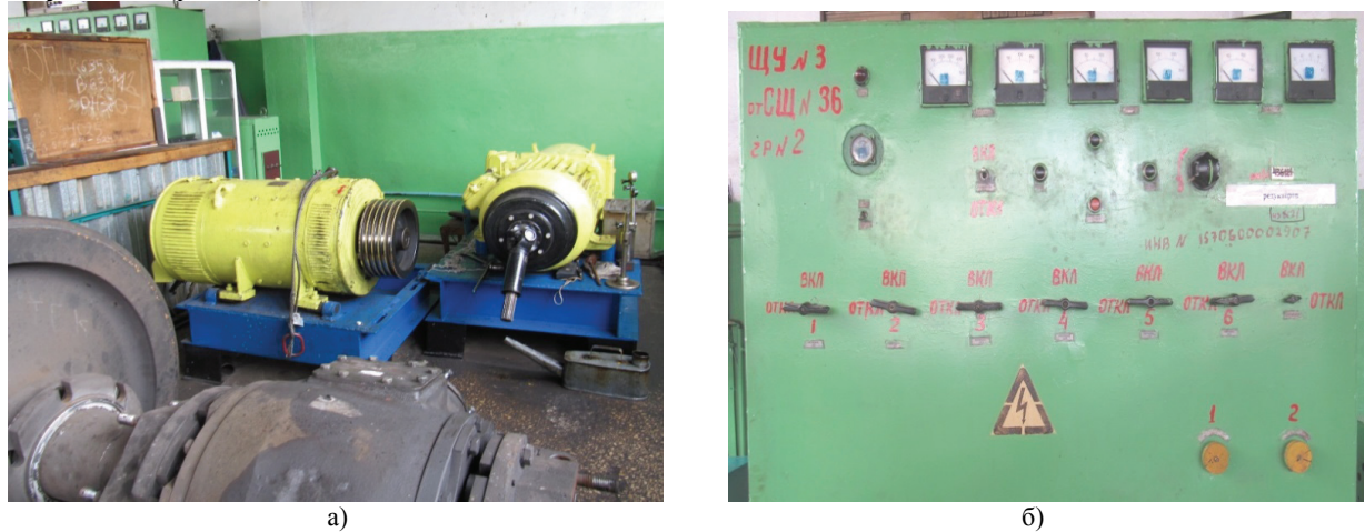
Рис. 1. Типовий випробувальний стенд для редукторів пасажирських вагонів, який експлуатується з 1974 року у пасажирському вагонному депо станції Одеса-Головна: а — загальний вигляд електроприводу і генератора типу DUGG 28B (28 кВт); б — панель ручного управління з 6-ма ступенями навантаженням генератора (редуктора)
