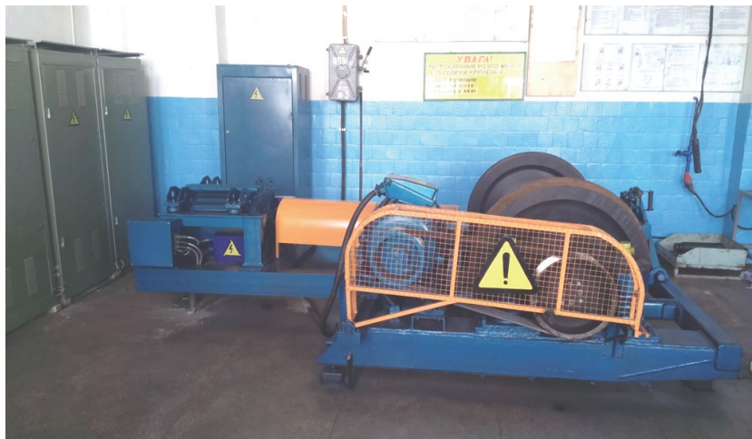
Рис. 2. Стенд моделі «ВІР-1500» для випробування редукторів пасажирських вагонів, який експлуатується у вагонному депо станції Бахмач
