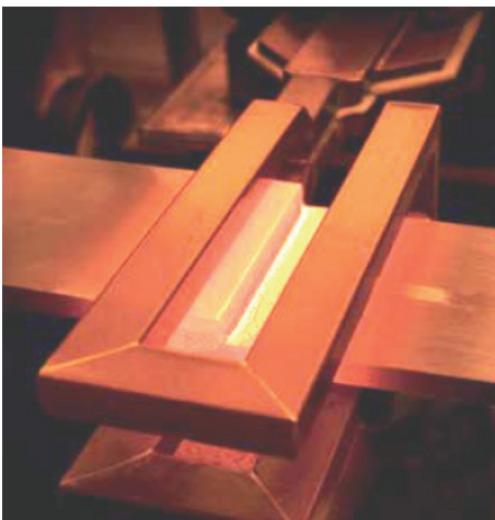
Рис. 2. Індукційне паяння мідних шин тугоплавким припоєм
