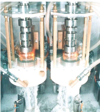
Рис. 1. Поверхнєве загартування розподільних валів з миттєвим охолодженням
