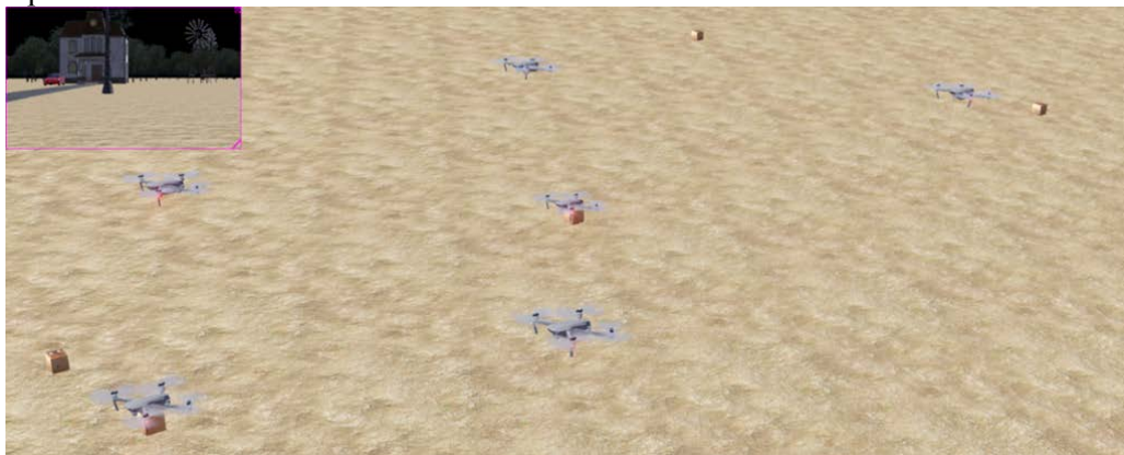
Рис. 2. Віртуальний світ, створений в середовищі WeBots, для експериментальної перевірки ефективності переміщення вантажів на основі мурашиного алгоритму за допомогою групи БПЛА
