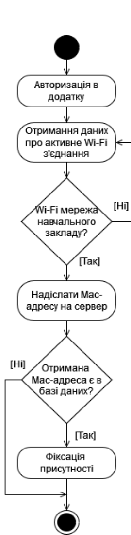
Рис. 1. UML-діаграма діяльності автоматизованої системи обліку відвідуваності на базі технології Wi-Fi Hotspot
