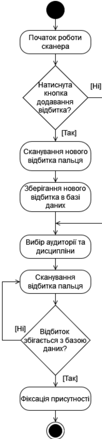
Рис. 5. UML-діаграма діяльності автоматизованої системи обліку відвідуваності на базі технології сканування відбитка пальця
