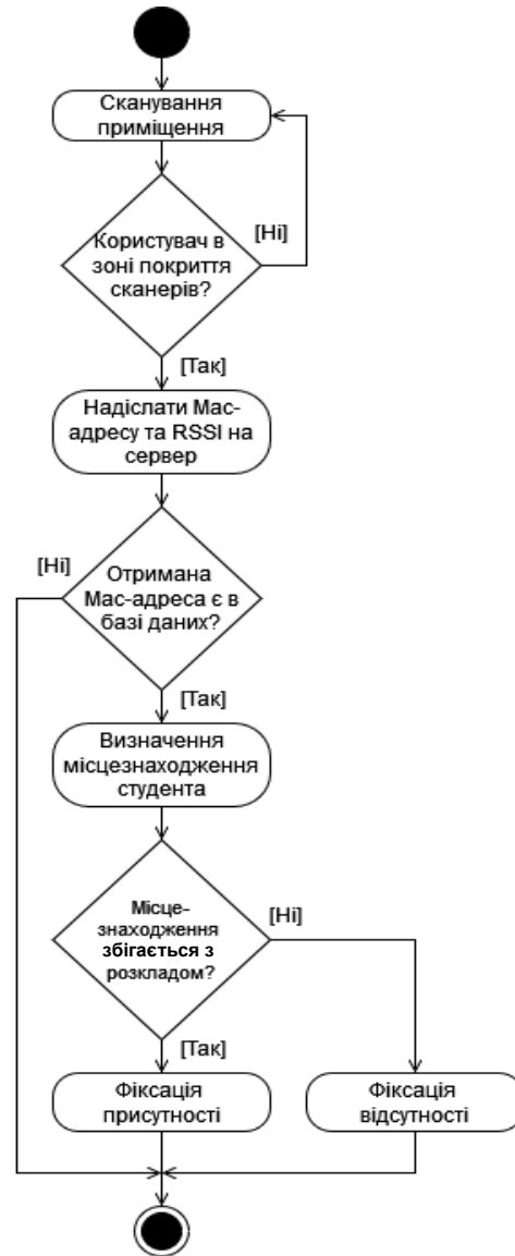
Рис. 2. UML-діаграма діяльності автоматизованої системи обліку відвідуваності на базі технології Bluetooth
