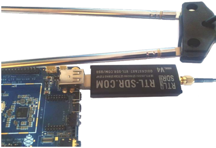
Рис. 5. Приймач RTL-SDR з дипольною антеною, підключений до одноплатного комп'ютера Pine A64
