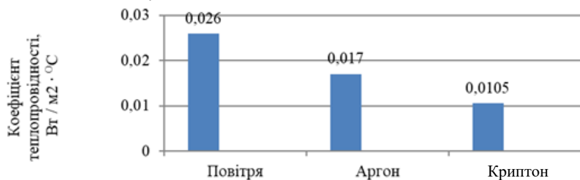
Рис. 4. Коефіцієнт теплопровідності повітря та інертних газів за температури 10 °С
