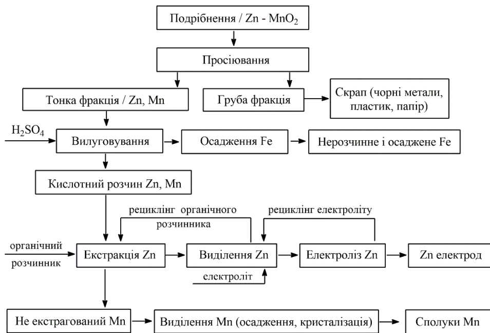
Рис. 3. Загальна схема гідрометалургійного рециклінгу відпрацьованих Zn – MnO_2 хімічних джерел струму
