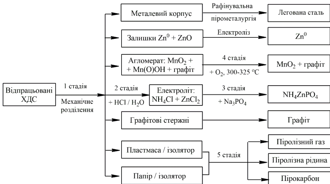
Рис. 5. Загальна схема комплексної переробки відпрацьованих \text{MnO}_2 – Zn хімічних джерел струму: 1 стадія — механічне розділення; 2 стадія — відмивання електролізу \text{NH}_4\text{Cl} + \text{ZnCl}_2 + [\text{Zn}(\text{NH}_3)_2]\text{Cl}_2 ; 3 стадія — отримання подвійної солі \text{NH}_4\text{ZnPO}_4 ; 4 стадія — регенерація \text{Mn}(\text{O})\text{OH} ; 5 стадія — піроліз без доступу кисню повітря
