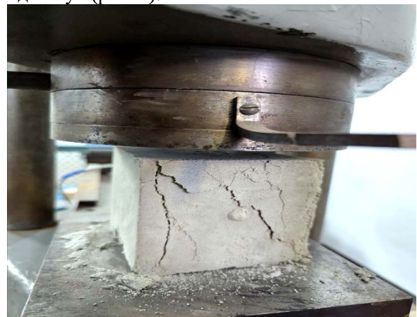
Рис. 4. Руйнування зразка газобетону
