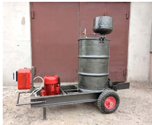
Рис. 2. Установка для приготування ніздрюватих бетонів в металі
