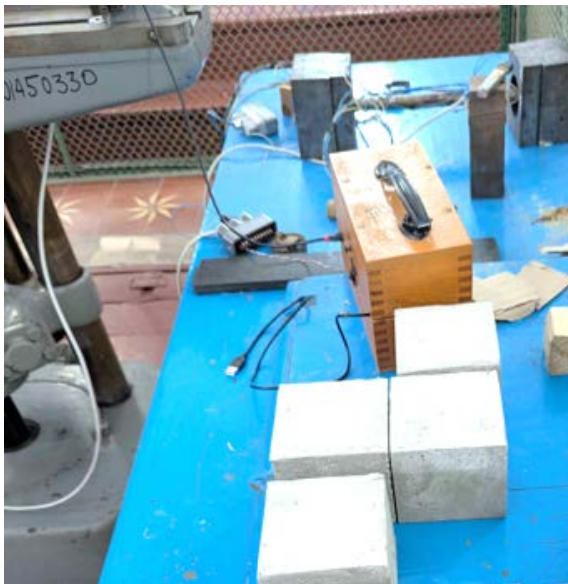
Рис. 3. Зразки газобетону 100 \times 100 \times 100 мм
