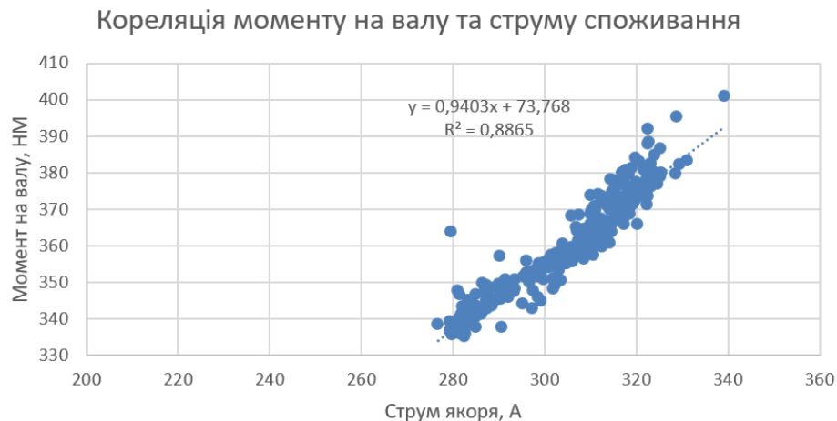
Рис. 6. Кореляція моменту на валу та струму споживання в режимі гальмування
