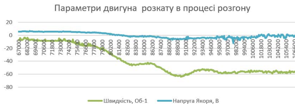
Рис. 1. Графік змін швидкості та напруги якоря під час розгону
