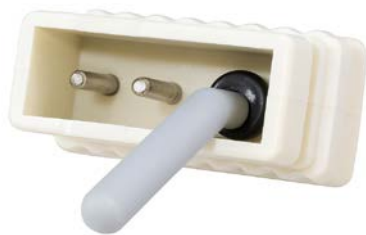
Рис. 3. Розроблений засіб вимірювання концентрації NaCl у воді
