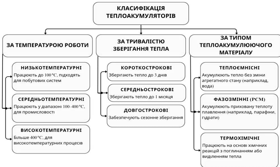
Рис. 3. Класифікація теплоаккумуляторів за температурою роботи, тривалістю зберігання тепла та типом теплоакуючого матеріалу
