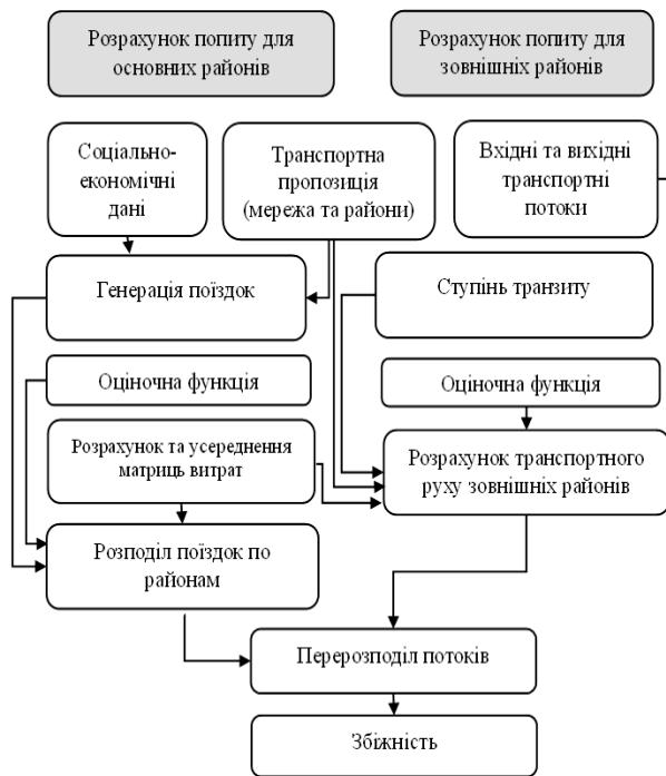
Рис. 1. Структурна схема моделювання транспортного попиту
