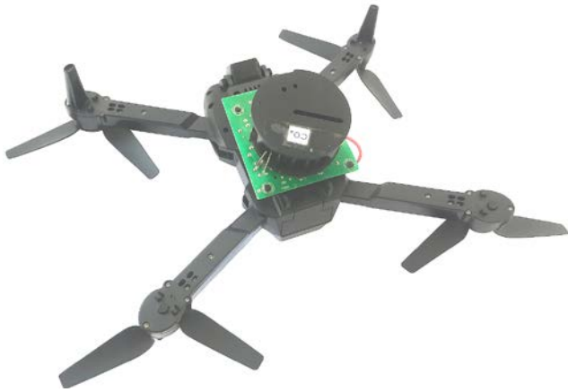
Рис. 2. Апаратне виконання оптичного безпілотного засобу (по каналу \text{CO}_2 )
