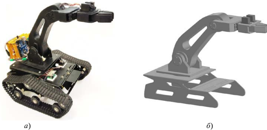
Рис. 2. Чотирьохосьовий робот-маніпулятор: а — загальний вигляд; б — 3D модель
