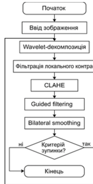
Рис. 4. Блок-схема алгоритму адаптивної компенсації завад
