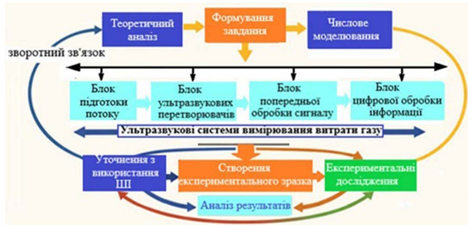
Рис. 1. Ітераційна модель науково-інженерного циклу проектування ультразвукових інформаційно-вимірювальних систем витрати газу
