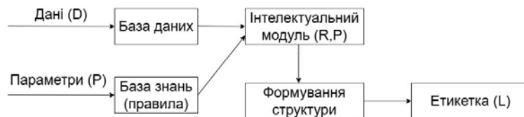
Рис. 2. Архітектура адаптивної моделі генерації бирок в ERP-системах: D — дані ERP-системи; R — множина продукційних правил; P — параметри користувача; L — сформована етикетка
